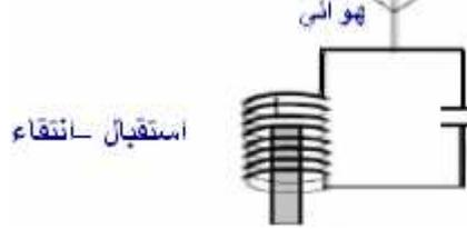
عند ربط الدارة LC بهوائي مستقبل للموجات الكهرومغناطيسية التي ترسلها المحطات الإذاعية، ينشأ توتر كهربائي في الهوائي. ولإنتقاء إرسال واحد أو محطة يلزم التوفيق بين التردد الخاص  $f_0$  للدارة LC التي تستقبل الإرسال وتردد الموجة المنبعثة من المحطة ، ويتم ذلك بتغيير معامل التحريض ، أو سعة المكثف .
